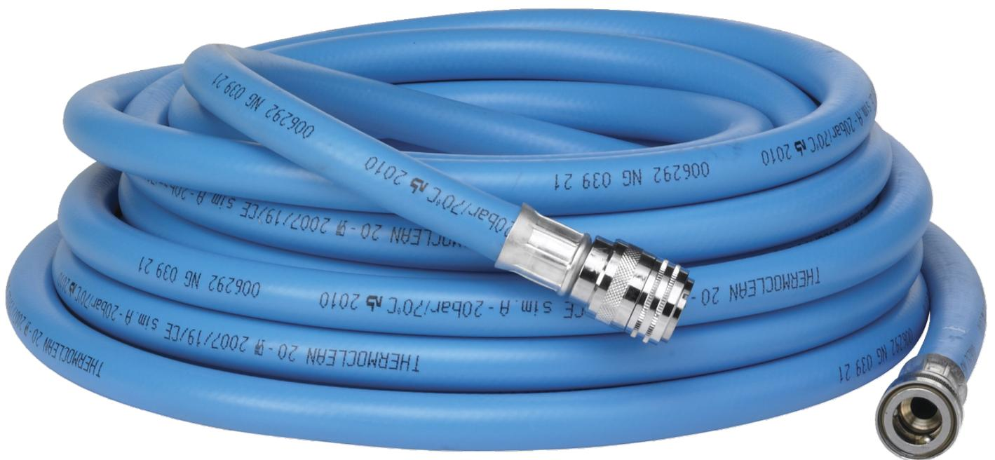
Questo tubo per acqua calda è ideale per la pulizia con acqua fino a 70 ° C. È dotato di un raccordo da 1/2" su entrambe le estremità del tubo. Nipplo del rubinetto, 0700 fornito per 1/2", 3/4 "e tipi di filettatura M22x1. Può essere utilizzato con i seguenti raccordi Vikan, 0700, 0705 e 0712 e con altri prodotti Vikan dotati di nipplo da 1/2 ".
