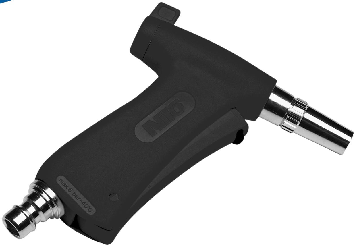
Ce pistolet est utilisé pour le rinçage et le nettoyage à l'eau froide. Une buse réglable permet de passer d'un jet ciblé à un jet pluie. Comporte une alimentation en eau à variation continue, une gâchette dotée d'un dispositif d'ouverture et de fermeture, et un raccord 1/2".
