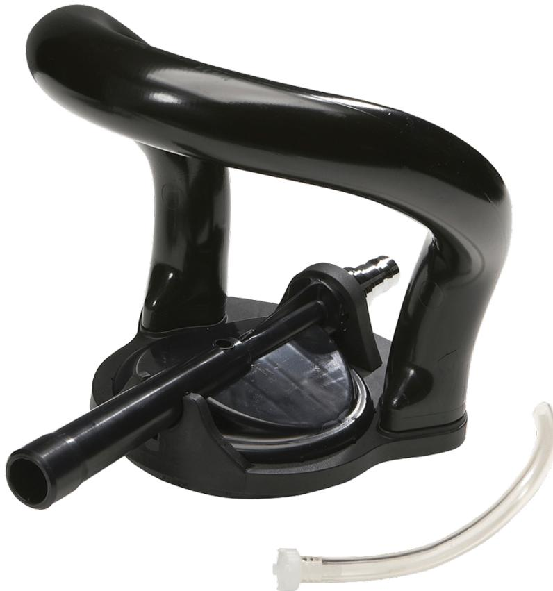
Der Ergo-Injektor mit Saugschlauch weist einen ergonomischen Griff mit Schauminjektor für die Reinigung mit Schaum auf. Er stellt sicher, dass Wasser und Reinigungsmittel immer im richtigen Verhältnis (0,15 bis 10 %) gemischt und auf die Flächen aufgetragen werden. Der Injektor passt auf große und kleine Behälter. Saugschlauch und Filter sind im Lieferumfang enthalten.
